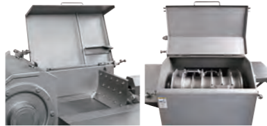
トップカバー・フロントカバーに安全装置付
