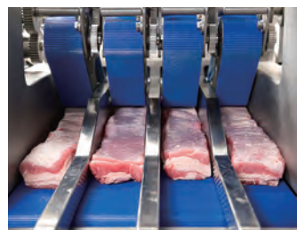
[原料投入側] 上下の肉送りでしっかりホールド。 正確な厚みでスライスされます
